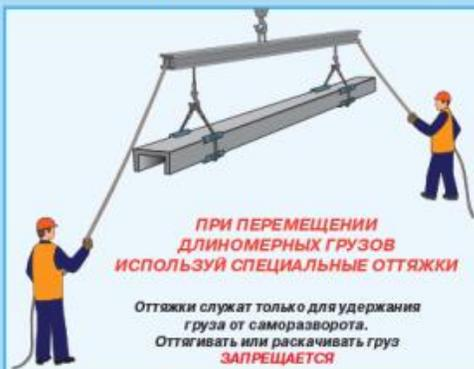
**ПРИ ПЕРЕМЕЩЕНИИ ДЛИНОМЕРНЫХ ГРУЗОВ ИСПОЛЬЗУЙ СПЕЦИАЛЬНЫЕ ОТТЯЖКИ**
