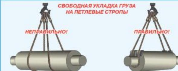
Допускается только при наличии элементов, предотвращающих продольное перемещение груза
