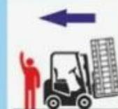
ДВИГАТЬСЯ ЗАДНИМ ХОДОМ, ЕСЛИ ГРУЗ ЗАКРЫВАЕТ ВИДИМОСТЬ ВОДИТЕЛЮ. ОБЕСПЕЧИТЬ СОПРОВОЖДЕНИЕ ДЛЯ ПОДАЧИ СИГНАЛА ОБ ОПАСНОСТИ
