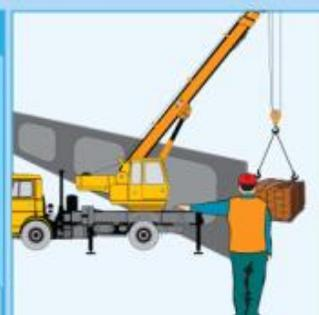
Если зона, обслуживаемая краном, не видна крановщику, то для передачи сигналов назначают сигнальщика
