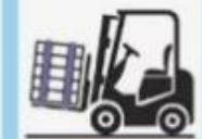
ЗАКРЕПИТЬ ГРУЗ НА ВИЛАХ, ЕСЛИ ЕСТЬ ОПАСНОСТЬ ЕГО ПАДЕНИЯ ИЛИ ОПРОКИДЫВАНИЯ
