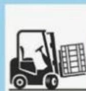
ПРИ ПОВОРОТАХ СНИЖАТЬ СКОРОСТЬ ВО ИЗБЕЖАНИЕ ОПРОКИДЫВАНИЯ
