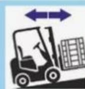
С ГРУЗОМ ДВИГАТЬСЯ ПОД УКЛОН ЗАДНИМ ХОДОМ, А НА УКЛОН - ПЕРЕДНИМ
