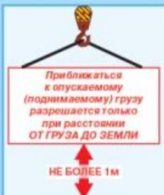
Приближаться к опускаемому (поднимаемому) грузу разрешается только при расстоянии ОТ ГРУЗА ДО ЗЕМЛИ
