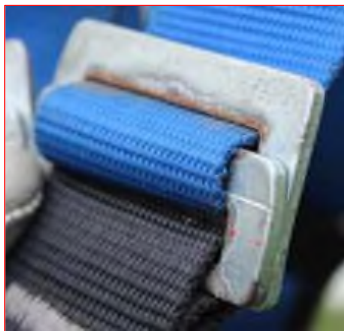
Регулировочные пряжки со следами коррозии
