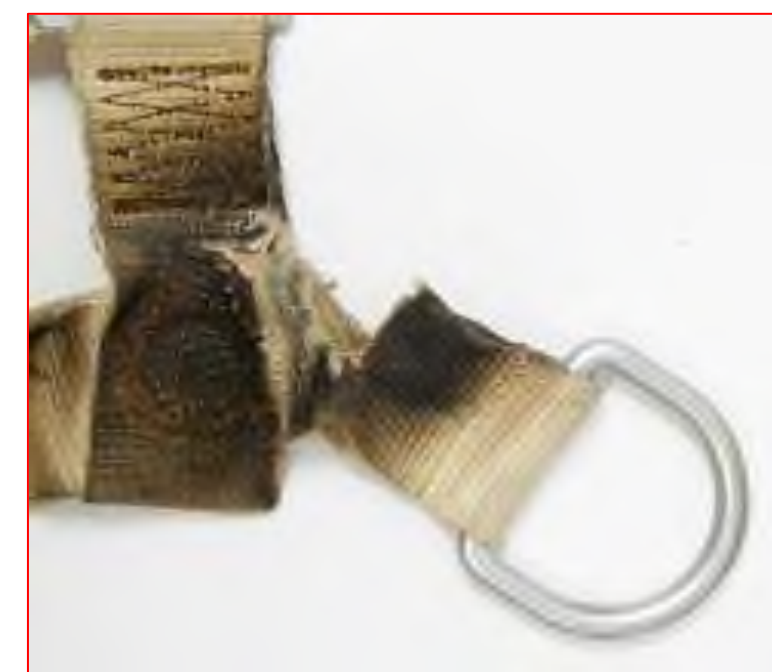
Лента, подвергшаяся тепловому воздействию
