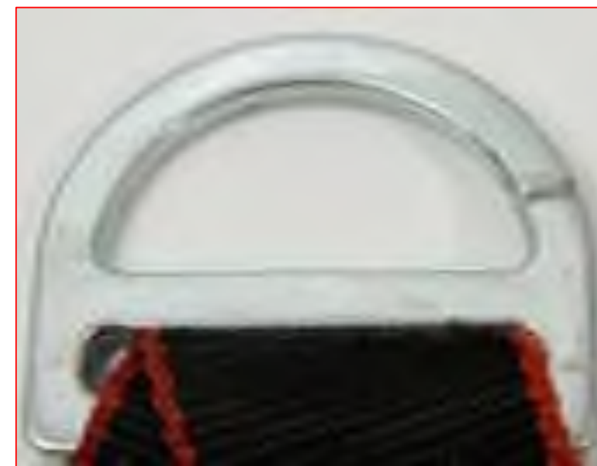
Страховочная точка на привязи с трещиной
