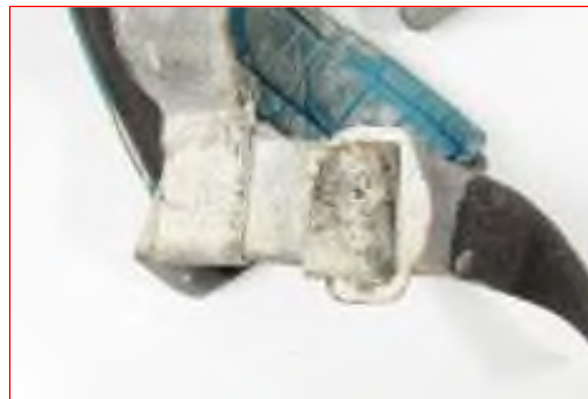
Лента со следами химического воздействия
