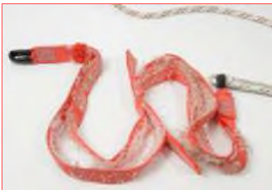
Пример сшитого амортизатора после остановки падения
