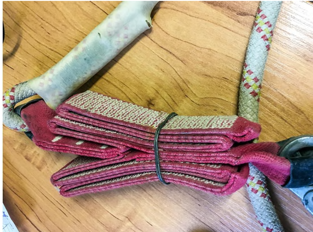
Повреждение защитного чехла амортизатора. Отсутствие маркировки
