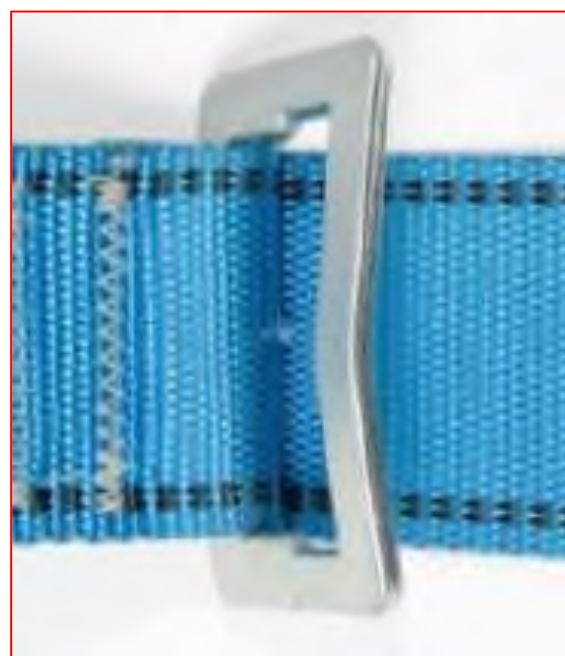
Деформированная регулировочная пряжка
